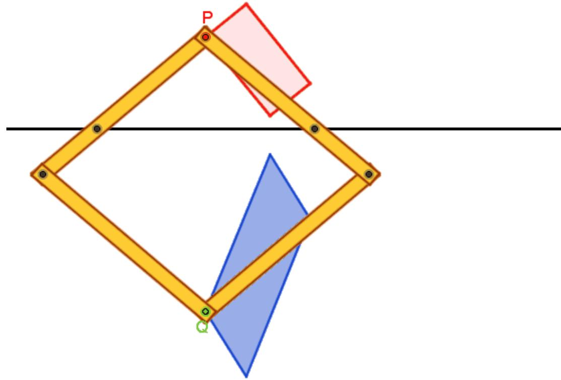
L'ultimo strumento esposto (sezioni del toro) collega la geometria greca alla geometria delle trasformazioni: le sezioni del toro, studiate per primo da Perseo nel II sec. a.C. vengono tracciate nel piano (in un caso particolare) da un biellismo che realizza una trasformazione geometrica non lineare.
