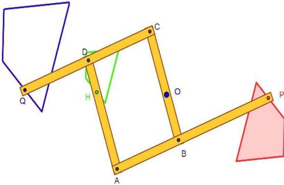
Il sistema articolato è costituito da quattro aste rigide incernierate nei punti A,B,C e D scelti in modo da formare un parallelogramma. Il punto O è fissato al piano su cui il meccanismo si muove. Il punto Q sull'asta CD è scelto in modo tale che risulti:
