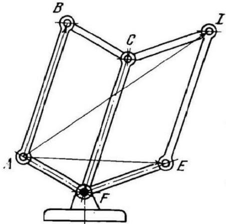
Il merito di Peaucellier, di Kempe, di Lipkin e altri, non è solo quello di essere riusciti a tracciare alcune curve particolari con questi sistemi, quanto di aver scoperto in questi sistemi una tecnica per realizzare le trasformazioni geometriche.
