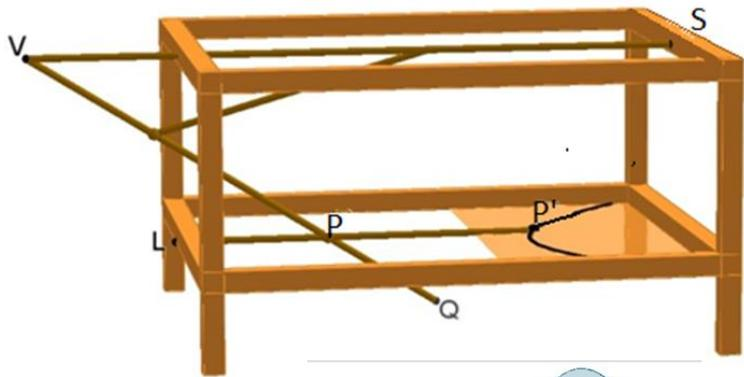
Due sbarre rigide VS, VQ sono saldate in V e formano un angolo  $\alpha$  prefissato. VS ruota in modo che VQ descriva parte di un cono di asse VS (sezione assiale di ampiezza  $\alpha$ ). VQ spinge un cursore posto in P: questo fa scorrere una terza sbarra LP' lungo guide rettilinee che la mantengono su un piano orizzontale parallelo ad LP' (a distanza prefissata). Quindi P descrive una iperbole, e l'asta LP' pilota una lama che incide la sagoma iperbolica.
