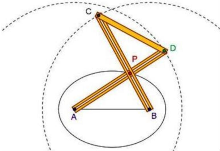
Si chiama antiparallelogramma articolato un quadrilatero (piano) articolato ABCD due lati opposti del quale (AB, CD) sono i lati non paralleli di un trapezio isoscele, mentre gli altri due lati (AD, BC) sono le diagonali del trapezio. Collochiamo l'antiparallelogramma su un piano  $\pi$ ; supponiamo di bloccare su  $\pi$  una delle aste piú corte (per esempio AB: fissando un perno in A e un altro in B), e muoviamo l'asta AD.
