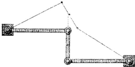
Nel 1784 James Watt, l'inventore della macchina a vapore, ottenne una soluzione approssimata del problema: in determinate condizioni il punto centrale del braccio di connessione si muove in un modo tale da discostarsi minimamente da una linea retta, ma studiando il meccanismo si può osservare che tale punto descrive un arco di una curva di sesto grado.
